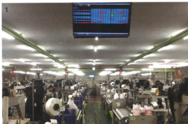
1.IoT化により、無人化が進む丸井織物の工場 2.コントロール室のモニターで織機の稼働率などを管理
