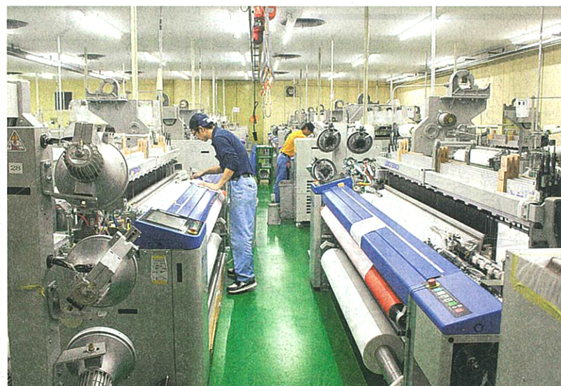
丸井織物本社工場で稼働するエアジェット型織機 —石川県中能登町
